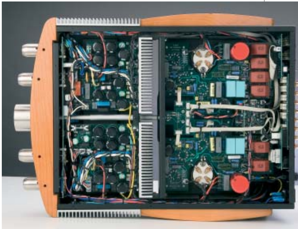
L'ingresso fono è collocato su una basetta sospesa, ovviamente allo scopo di minimizzare la trasmissione delle vibrazioni. L'anello semichiuso che circonda il triodo d'ingresso, di gran lunga il più esposto alla microfonicità, ha scopo analogo rispetto alla tendenza risonante del vetro dei tubi.
